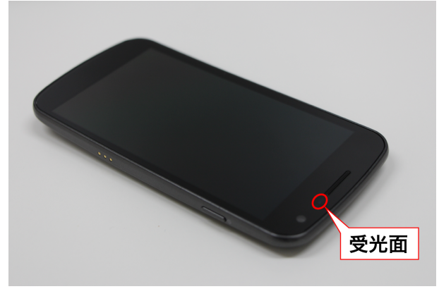
図 5 スマートフォン搭載照度センサの受光面
