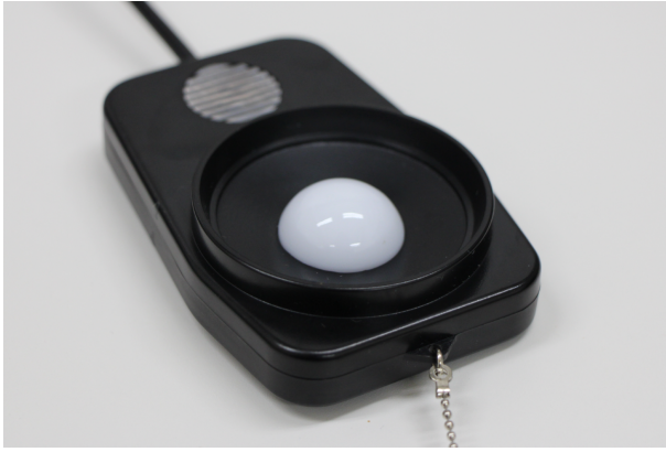
図 4 一般的な照度計の受光面
